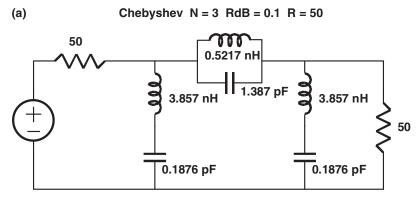
Band Stop Filter @ 0:5 GHz and 7: ∞ GHz
